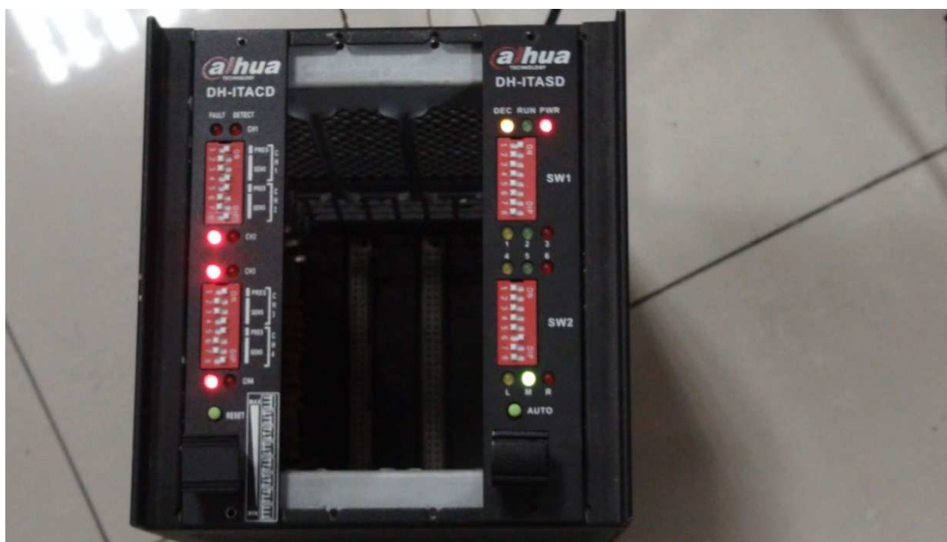
Rys.17 Detektor pojazdów ITACD-004A oraz detektor sygnałów ITASD-012A
